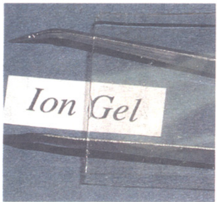
イオン液体から作られた薄膜状のイオンゲル (いずれも渡辺正義・横浜国立大教授提供)
